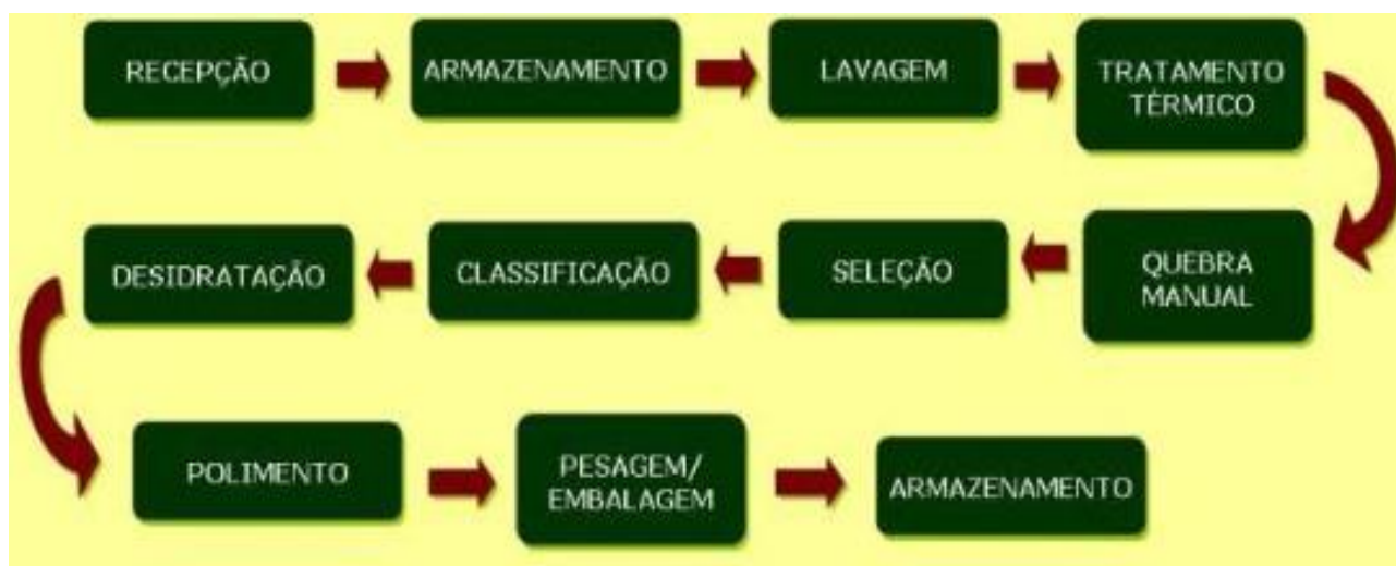
Figura 36: Organograma do processo de chegada da castanha até o processo final. Fonte: Aguiar, 2024.
