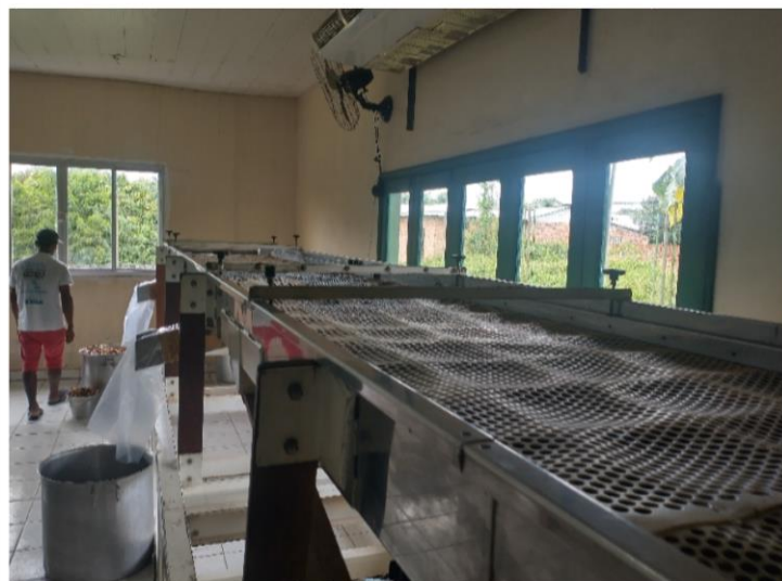
Figura 26: Máquina de classificação de castanha por tamanho. Fonte: Aguiar, 2024
