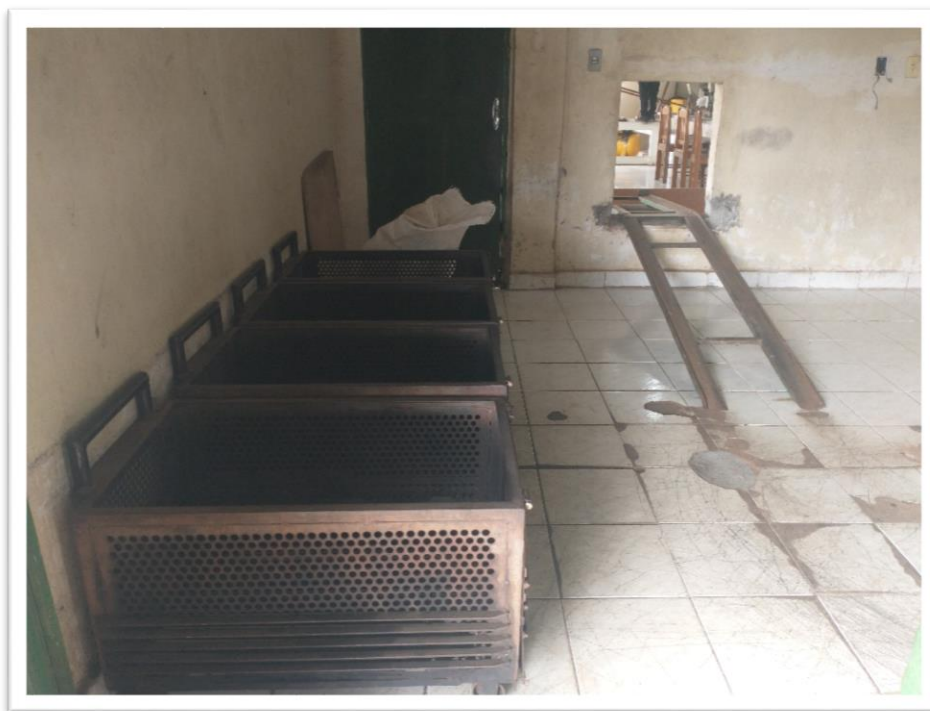
Figura 23: Estrutura de ferro que compõe a parte de alto clave. Fonte: Aguiar, 2024
