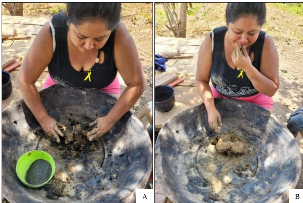
Figuras 9 A, B – Preparo da massa para a modelagem da argila
